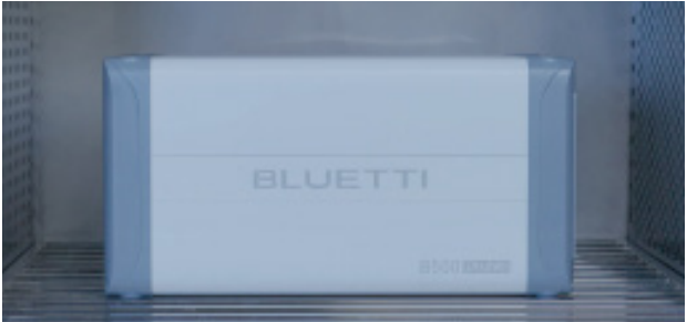
Défi des températures extrêmes Test de choc froid de 3 minutes sur le B500, mettant en évidence les performances dans des températures extrêmes.
