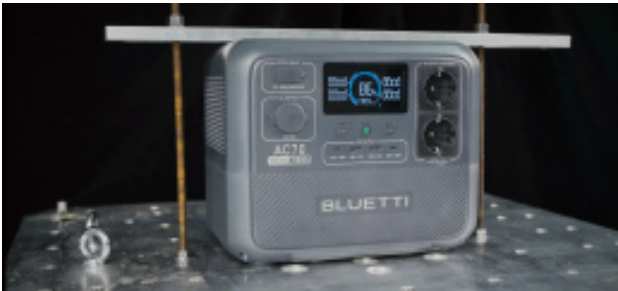
Test de restauration du scénario de transport 100% de récupération après un mouvement vertical de 50 mm pendant 30 minutes.
