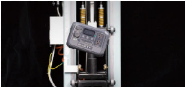
Stoßfestigkeitstest Spitzenbeschleunigung von 150 m/s 2 , beweist Widerstandsfähigkeit gegen starke Stöße.
